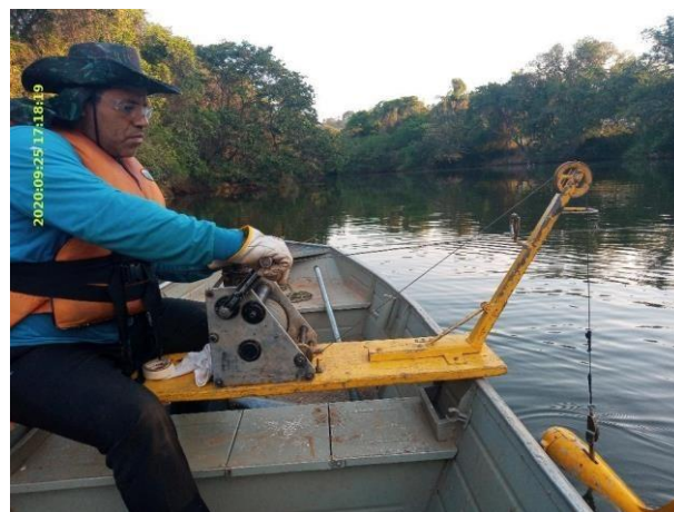
Foto 2 – Coleta de dados com o amostrador de sedimentos PHM. (Data: 25/09/2020).
