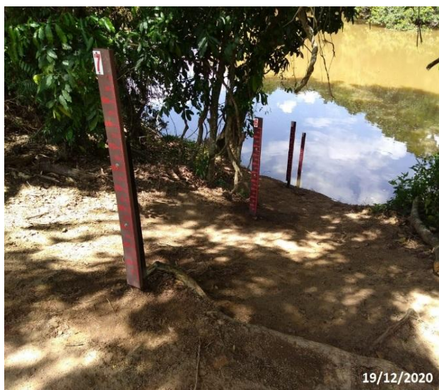
Foto 7 – Vista das régulas de monitoramento do PHM. (Data: 19/12/2020).
